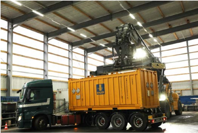
Ein mit belastetem Erdmaterial befüllter Spezialcontainer wird auf einen LKW verladen, der ihn zum Schiffsanleger transportiert; Quelle: Pressefoto Roche
