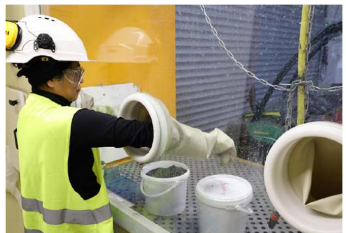
Eine Umweltnaturwissenschaftlerin bereitet im Schutze einer Glovebox das belastete Erdreich für die labortechnische Untersuchung vor. Quelle: Pressefoto Roche
