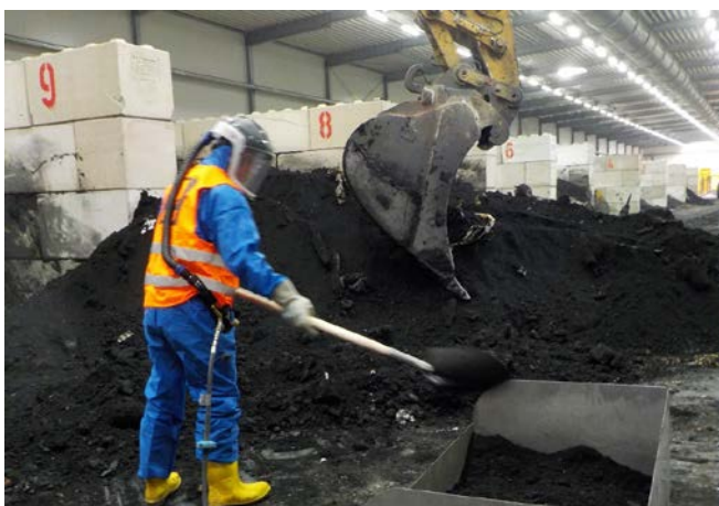
Ein Geologe entnimmt aus einer Sondercharge Erdmaterial zur Erstellung einer Mischprobe. Quelle: Pressefoto Roche
