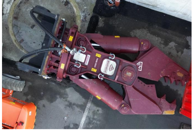
Die für den Betonabbruch eingesetzte, 14 Tonnen schwere Abbruchschere.
